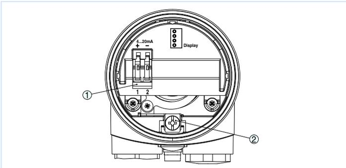
Compartiment électronique et de raccordement boîtier à chambre unique
